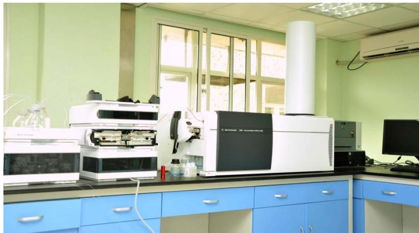
Agilent液相色谱串联飞行时间质谱联用仪
